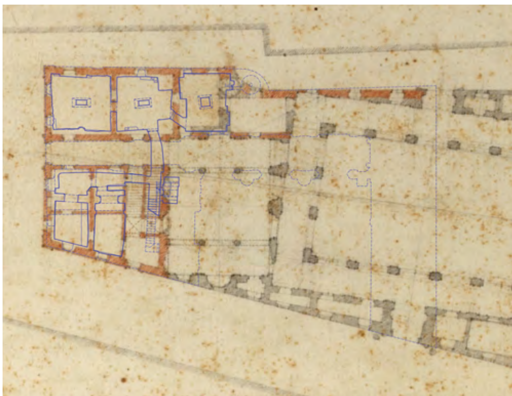
5. Il rilievo del piano delle cantine sovrapposto al disegno di Francesco Borromini, foglio Az.Rom1017a (Albertina, Vienna).
