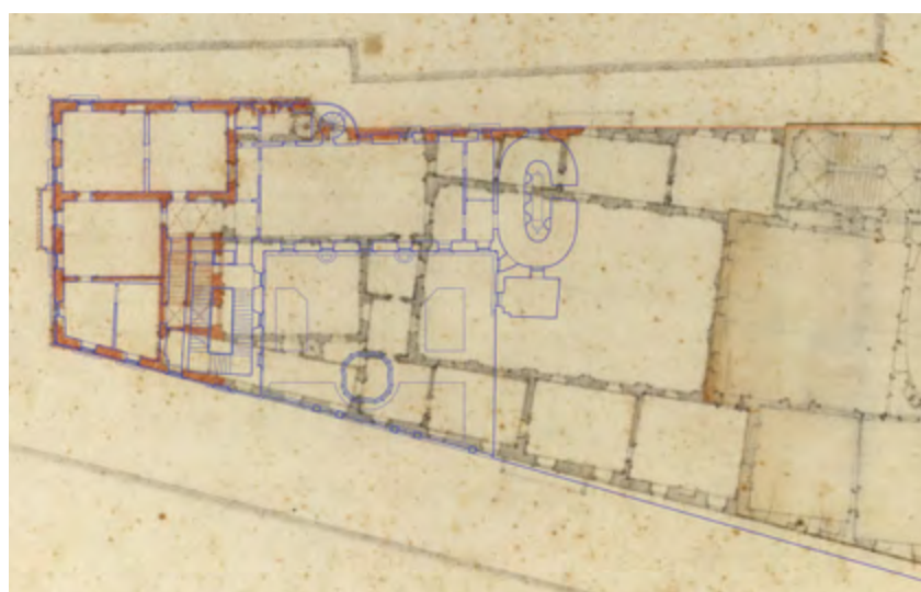
4. Il rilievo del piano terra sovrapposto al disegno di Francesco Borromini, foglio Az.Rom1017a, Albertina, Vienna (sopra) e quello del piano primo sovrapposto al foglio Az.Rom1017b (sotto).
