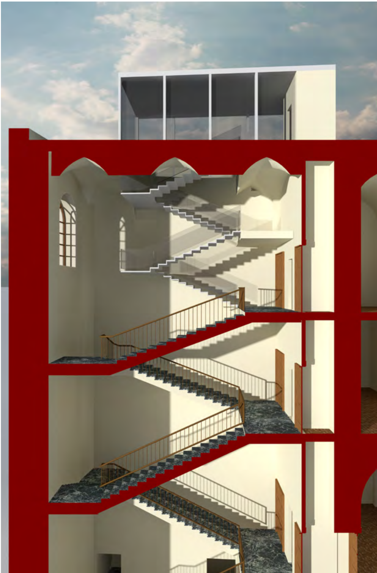
Spaccato prospettico lungo la scala principale.
