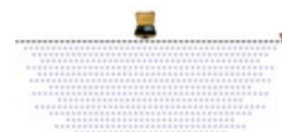
Esempio di disposizione spaziale 2D delle acquisizioni nel sottosuolo.
